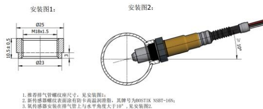
图 6 传感器安装示意图
